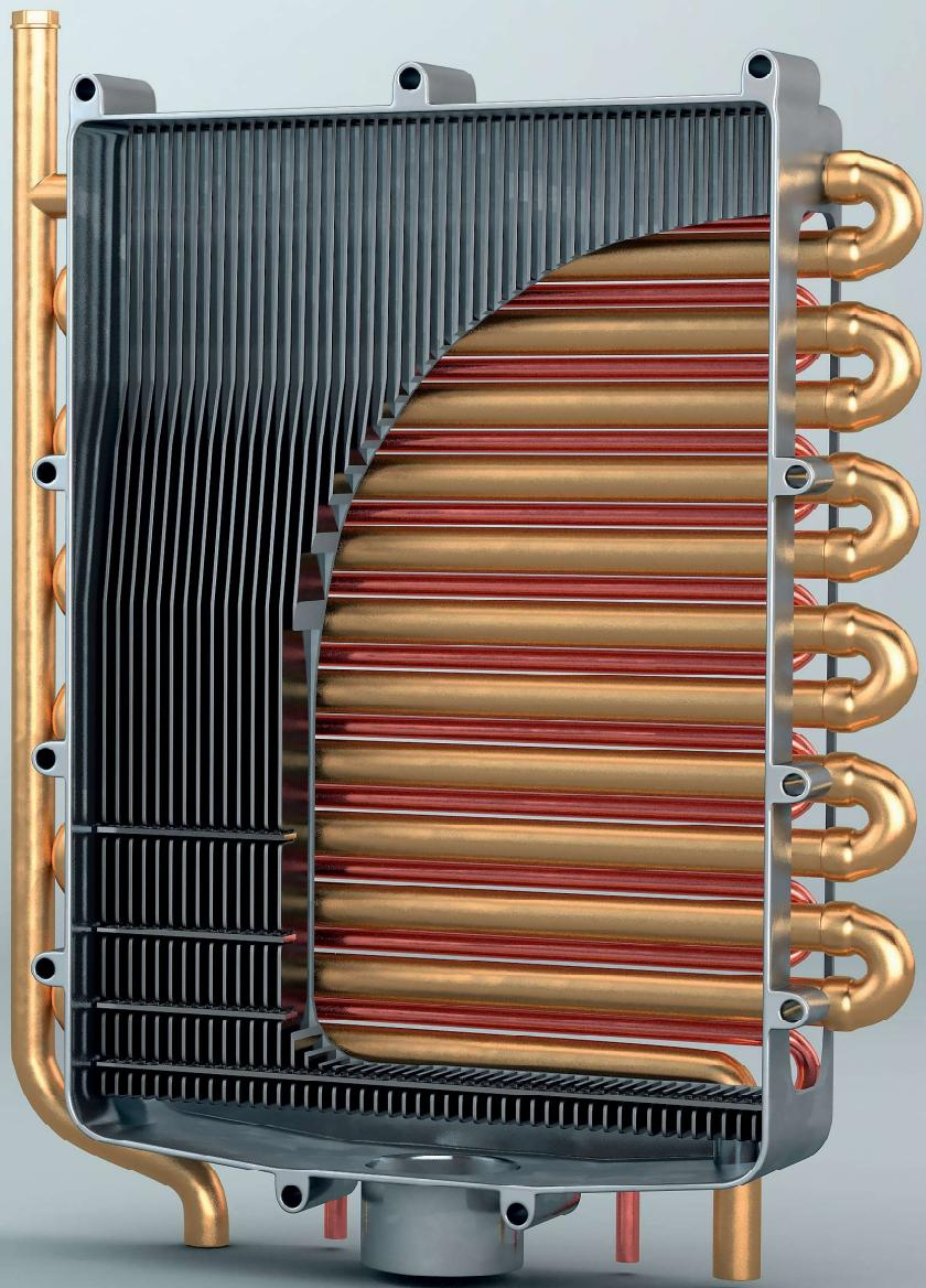
Kondenzační výměník je vyroben z masivního hliníkového bloku, do kterého jsou zalyty dva nezávislé měděné okruhy ÚT a průtokové přípravy TV.
